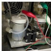
図1 開発した有機電解合成の装置
