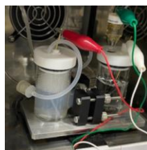
図1 開発した有機電解合成の装置
